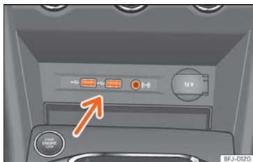
Fig. 236 Centre console: USB/AUX-IN input.
