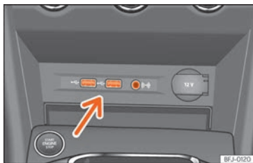
Fig. 239 Centre console: USB/AUX-IN input.
