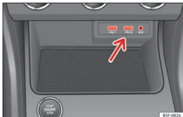
Fig. 128 Centre console: USB/AUX-IN input.
